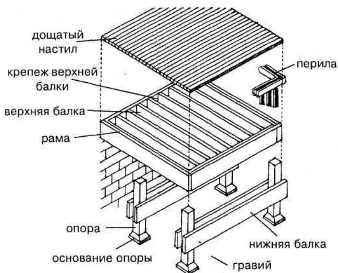
Рис. 26. Устройство высокой террасы
