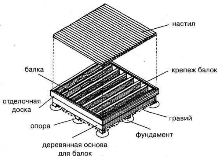
Рис. 24. Устройство низкой террасы
